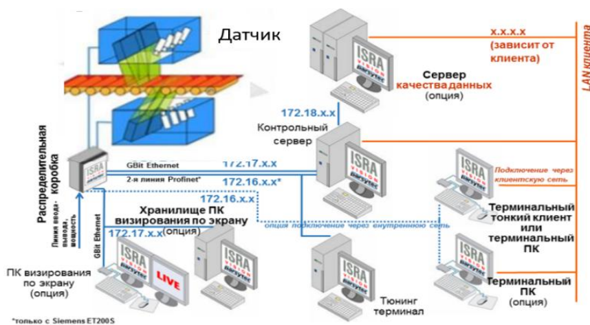
Рисунок 3 – Схема работы системы определения дефектов
