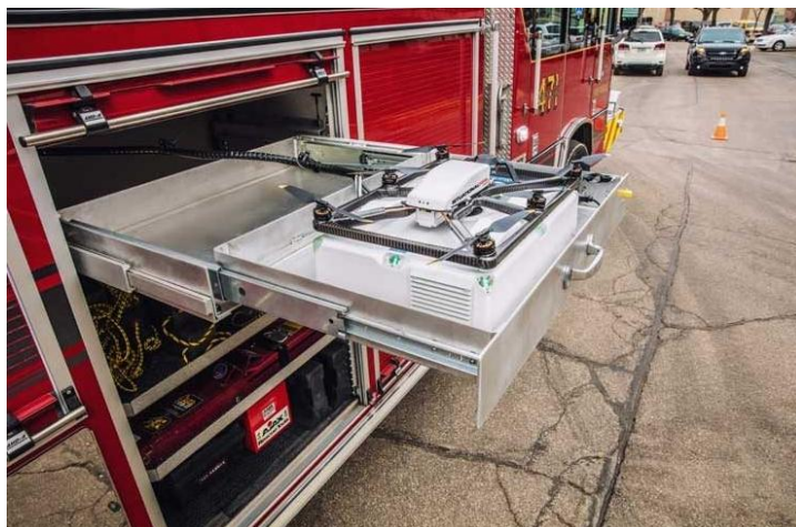
Рисунок 6. Фото. Квадрокоптер в специальном отсеке пожарной машины
