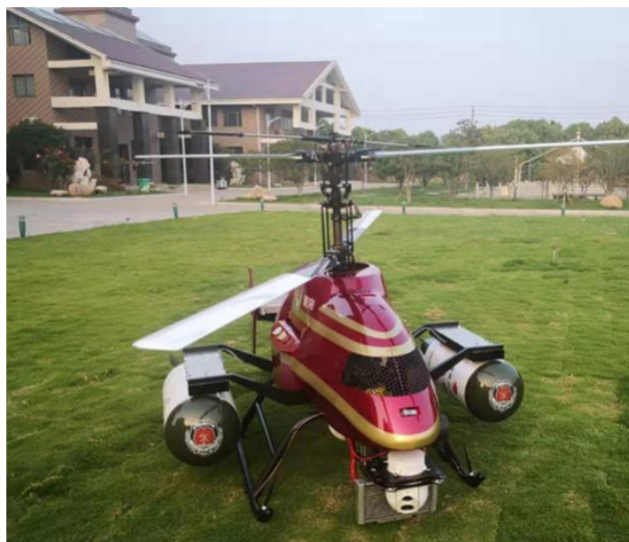
Рисунок 5. В комплект БПЛА входит 150 литров жидкостных огнетушащих веществ и видео камеры с тепловизором
