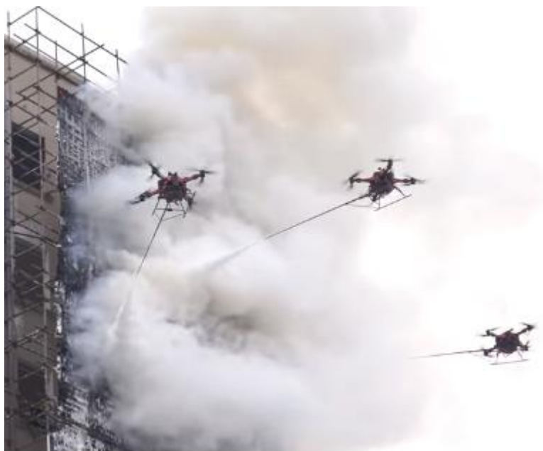
Рисунок 9. Активное тушение БПЛА с помощью подачи специальной пены для тушения огня в очаг пожара
