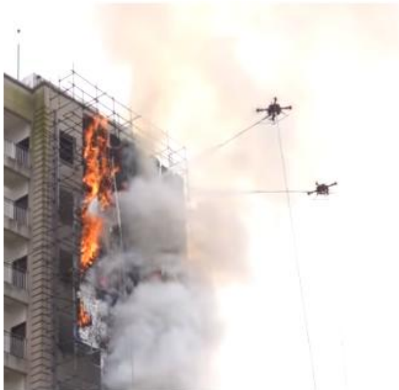
Рисунок 8. Активное тушение с помощью специальных БПЛА. БПЛА используется для подъема пожарного рукава на необходимую высоту
