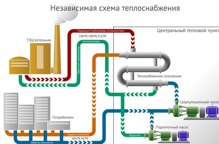
Рисунок 1. Схема централизованного теплоснабжения
