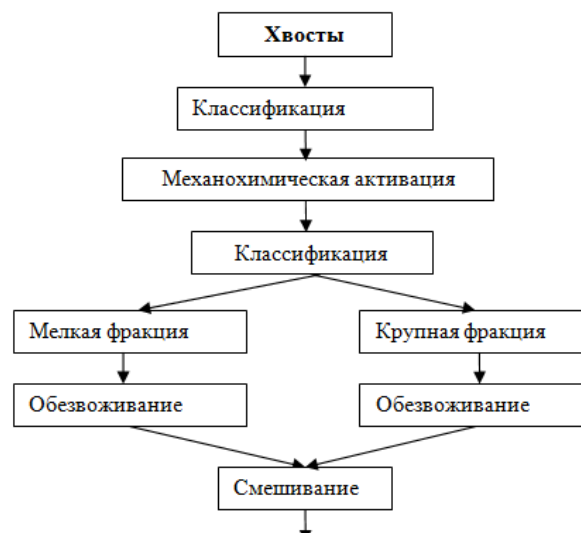
Рисунок 2. Схема приготовления твердеющей смеси на основе хвостов обогащения.
