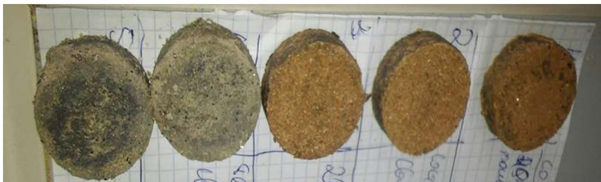
Рисунок 1. Образцы для исследований на прочность, изготовленные с использованием глин различных месторождений.
