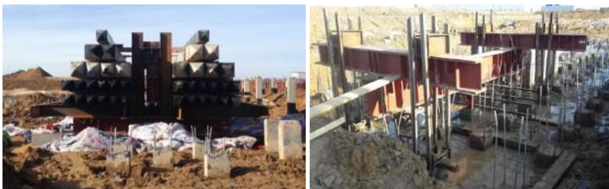
Рисунок 1. Статические испытания с применением пригрузочной платформы и анкерно-упорного стенда.
